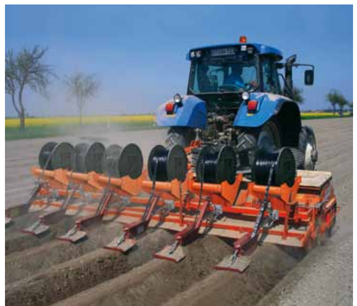
Die Verlegemaschine für die Tropfschläuche ist an vorhandener Technik montierbar. Die entsprechenden Plastiktrommeln nehmen Schläuche mit einer Gesamtlänge von 500 Metern auf. Bei der Hebeteknik können bis zu sechs Reihen gleichzeitig bedient werden.
