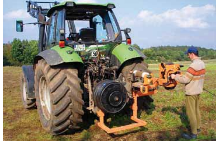
Zum Bergen der Tropfschläuche dient eine hydraulische Wickelmaschine, die den Schlauch auf die leeren Plastikspulen wickelt. Eine Trommel fasst 450 bis 500 Meter Tropfschlauch.
